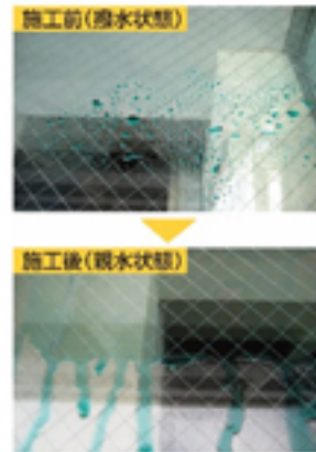
図① ガラスの表面にはシラノール基(Si-OH)が存在します。清浄な状態では親水状態です。しかしながら分子的には非常に不安定で、短時間で何らかの分子(汚れ等)と結合します(親水ではなくなる)。「ガラス親水コート剤」によってシラノール基に親水有機化合物を結合させ、安定な状態にして親水状態を長持ちさせます。
